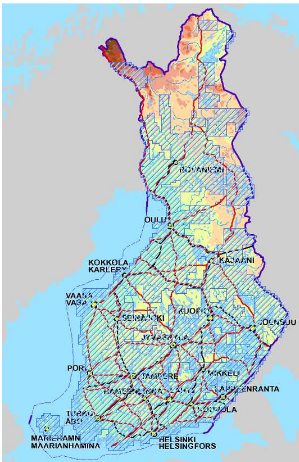
Kuva 1 Virtausverkko on laskettu kattavasti. Kuvassa on esitetty laserkeilauksen 2m maanpintamallin kattavuus. Välialueiden laskennassa on käytetty 10m – maanpintamallia.
